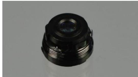
Schritt 5: Optikmodul eines iPhones 5s. Dieses wird als Objektiv für das Smartphone-Mikroskop verwendet.
